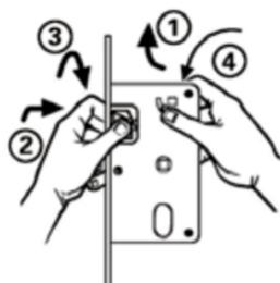
Verifique se o trinco está na posição correta permitindo o fechamento da porta. Se houver necessidade de inverter o trinco:
