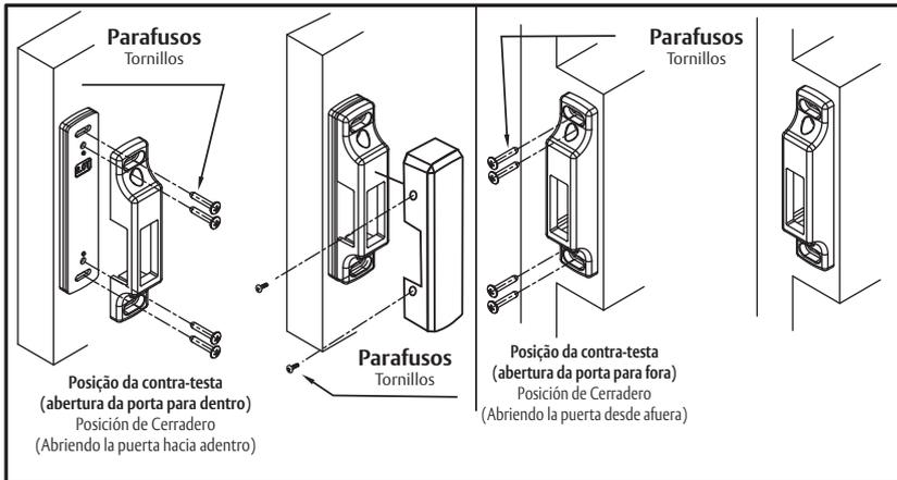
Para essa condição de montagem, não montar a tampa
